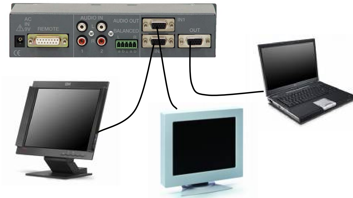
Fig. 2 Collegamento TZW203+ 1 sorgente 2 destinazioni
